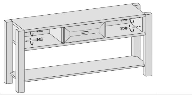
Hängen Sie den linken und rechten Schubkasten aus, sodass der Einhängekorpus noch mit den Füßen verschraubt werden kann. Nutzen Sie dazu die vorgebohrten Löcher mit den Schrauben 3,5x50mm.
