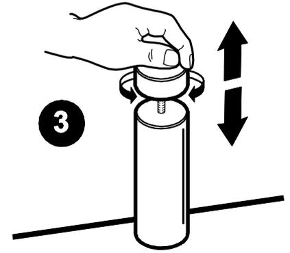
Verschrauben Sie den Universalstützfuß zusammen mit dem Elementverbinder an den originalen Anschraubpunkten. Entfernen Sie dafür den vorhandenen Verbinder und verschrauben ihn erneut zusammen mit dem Fuß an den vorhandenen Stellen sowie mit einer zusätzlichen Spaxschraube seitlich.
