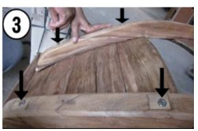
Setzen Sie die 4 Schrauben, wie gezeigt in die 4 Löcher ein. Stellen Sie sicher, dass der obere Teil der Schraube in das Loch gelangt. Der untere Teil der Schraube befindet sich im Inneren des Speichers.
