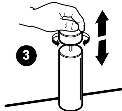
Verschrauben Sie den Universalstützfuß zusammen mit dem Elementverbinder an den originalen Anschraubpunkten. Entfernen Sie dafür den vorhandenen Verbinder und verschrauben ihn erneut zusammen mit dem Fuß an den vorhandenen Stellen sowie mit einer zusätzlichen Spaxschraube seitlich.
