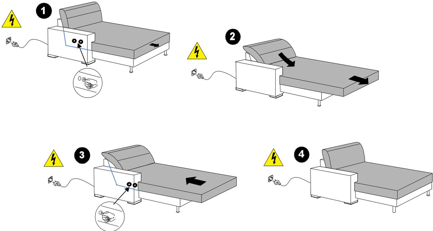
Der Longchair mit motorischer Verstellung ist mit verdeckten Schaltsensoren gearbeitet. Die Sensoren befinden sich seitlich am Sitzkissen der Armlehenseite
