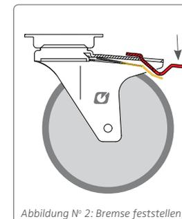
Abbildung N° 2: Bremse feststellen
