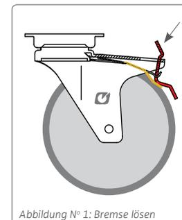
Abbildung N° 1: Bremse lösen
