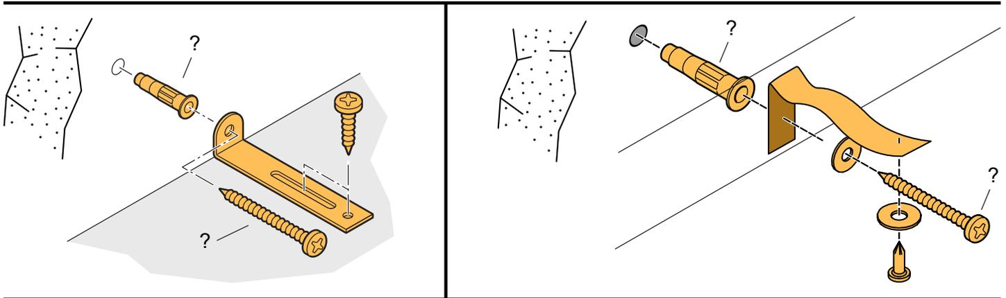
**D** Nach dem genauen Ausrichten ist eine Wandmontage aus Sicherheitsgründen, aber auch aus Funktions- und Stabilitätsgründen unbedingt notwendig. Das mitgelieferte Wandbefestigungsmaterial (Dübel, Schrauben) ist ausschließlich für die Befestigung an Beton und/oder festem Mauerwerk geeignet. Bei abweichender Beschaffenheit (z.B. Gipskarton- oder Leichtbauwände) ist entsprechendes Befestigungsmaterial im Fachhandel zu besorgen.
